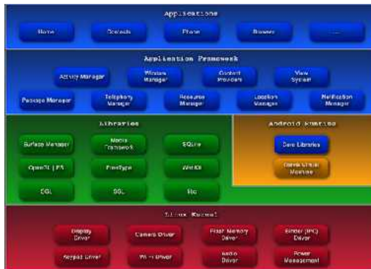
Gambar 2.11 Lapisan Arsitektur Aplikasi Android (Android Developer)
