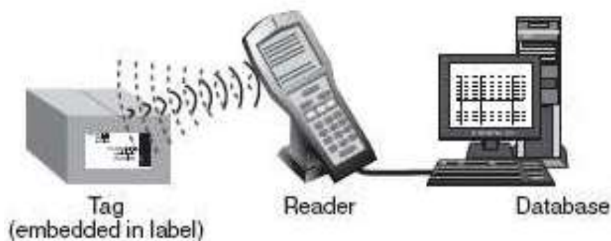
Gambar 2.1 Komponen Utama Suatu Sistem RFID
