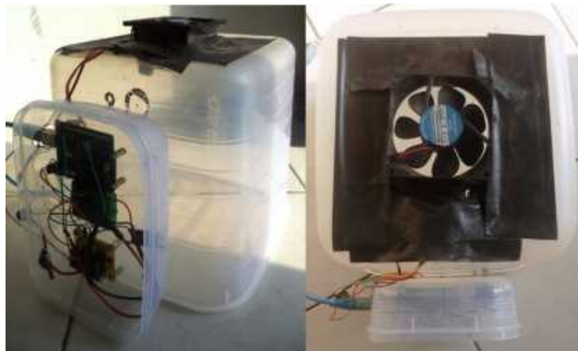
Gambar 4.3 Konstruksi ruangan dan blower
