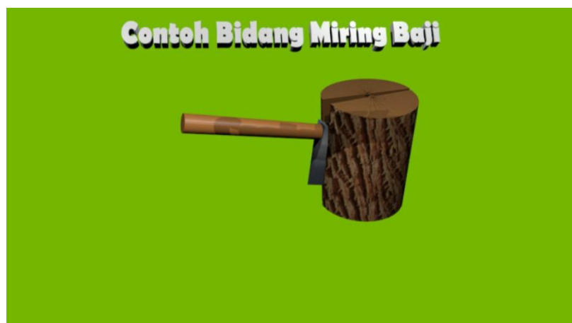
Gambar 4.19 Contoh bidang miring baji
