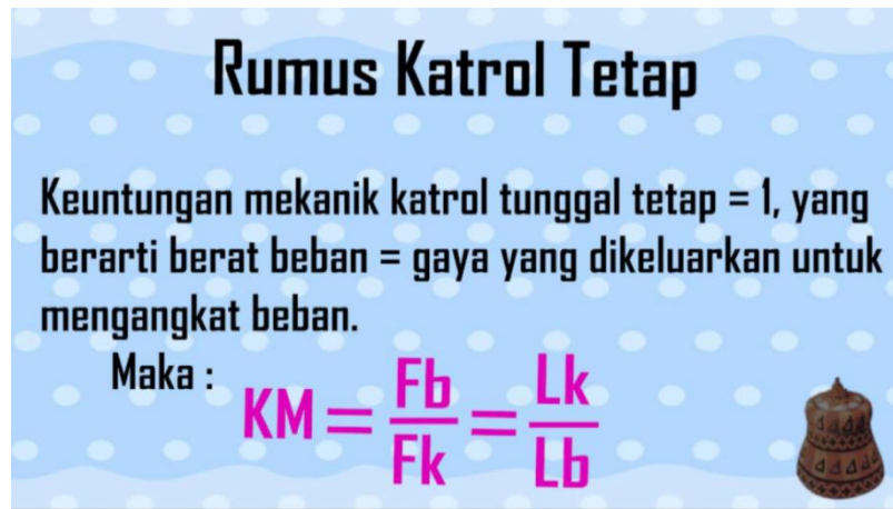
Gambar 4.13 Keuntungan mekanik katrol tunggal tetap
