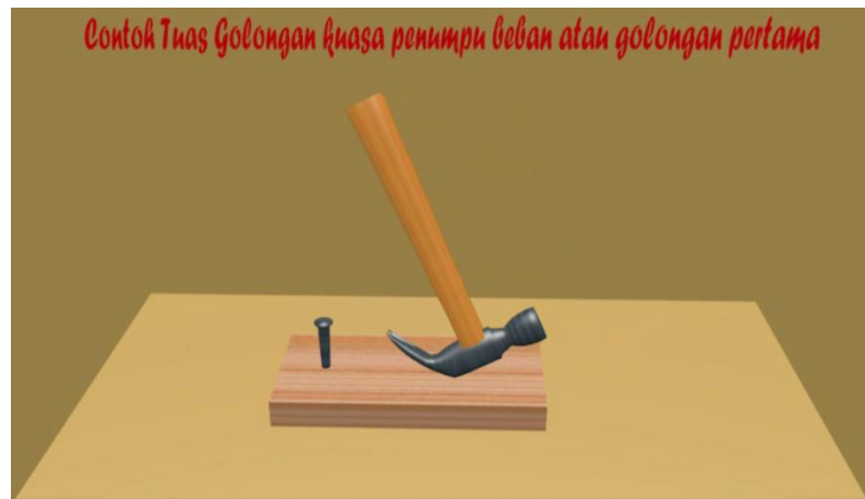
Gambar 4.5 Gambar tuas golongan satu
